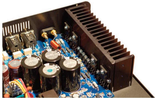
Im Prelude finden vier Endtransistoren pro Kanal Verwendung
