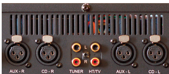
Vier Hochpegelquellen lassen sich am EC Prelude PI-2 anschließen
