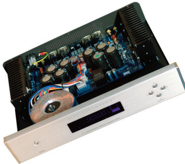
Im Prelude finden vier Endtransistoren pro Kanal Verwendung
